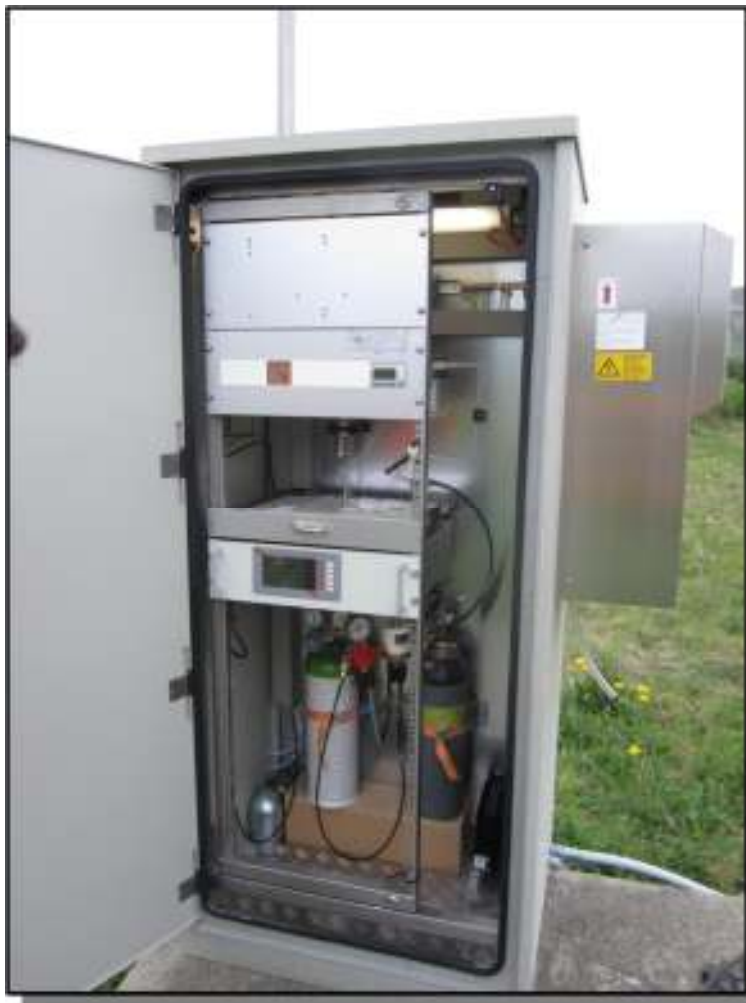
Analyse de H 2 S ambiant Basé sur un petit analyseur IRM750 Petit coffret avec conditionnement de l'échantillon gazeux
