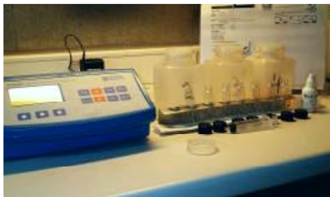
Analyse d'eau en laboratoire : principaux éléments: pH, EC, \text{NO}_2^- , \text{NO}_3^- , Ammonium, \text{SO}_3^- , \text{PO}_4^{3-} , ...
