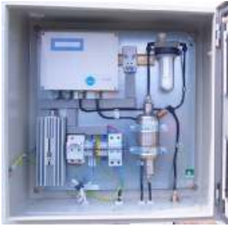
Analyse de H 2 S ambiant Basé sur un petit analyseur IRM750 Petit coffret avec conditionnement de l'échantillon gazeux
